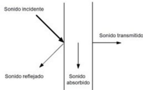
Figura 1. Diagrama de balance energético.
