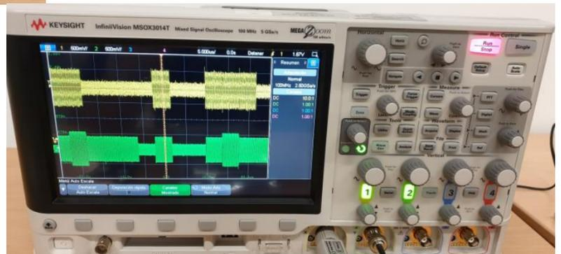
4. Modifique los esquemas de modulación utilizando el botón Mode Select y observe los cambios que existen en la señal banda-base, en la componente en fase y la señal de radiofrecuencia modulada.
